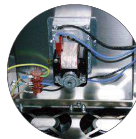
Ventilation des moteurs / Motors ventilation
